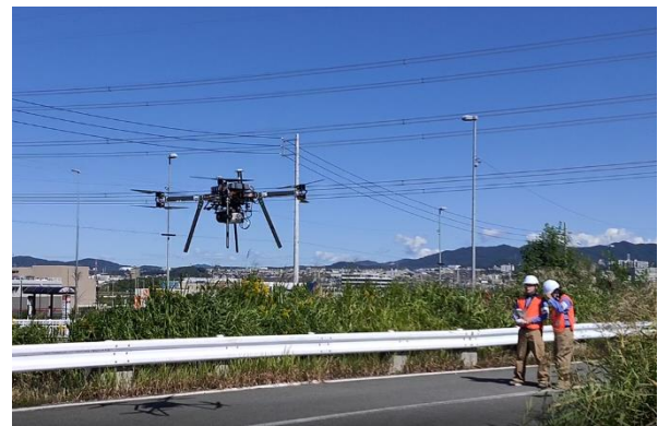
UAV レーザ測量の様子
