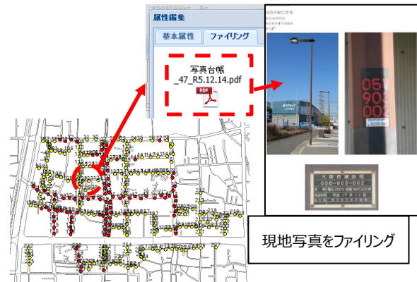
図11. GIS上での照明灯写真のファイリング
