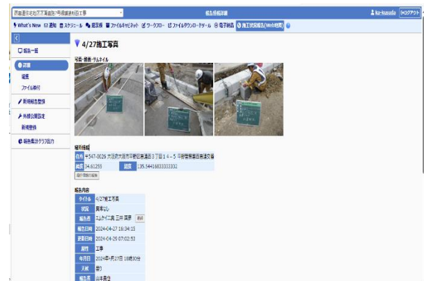
図8. 工事情報共有システム（施工写真管理画面）
